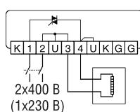
Внешний дополнительный термодатчик и устройство TG-R4XX в качестве задатчика настройки
