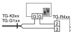
Регулирование температуры в помещении с применением устройства TG-R4XX в качестве термодатчика и задатчика
