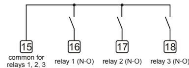
Fig. 4. Relay outputs
