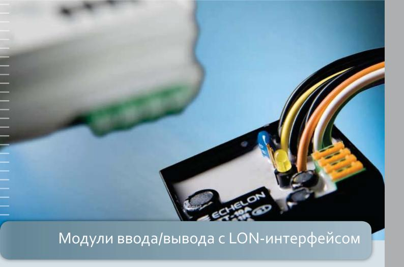
Цифровые модули ввода/вывода служат для определения состояния безпотенциальных контактов и управления через релейные выходы.
