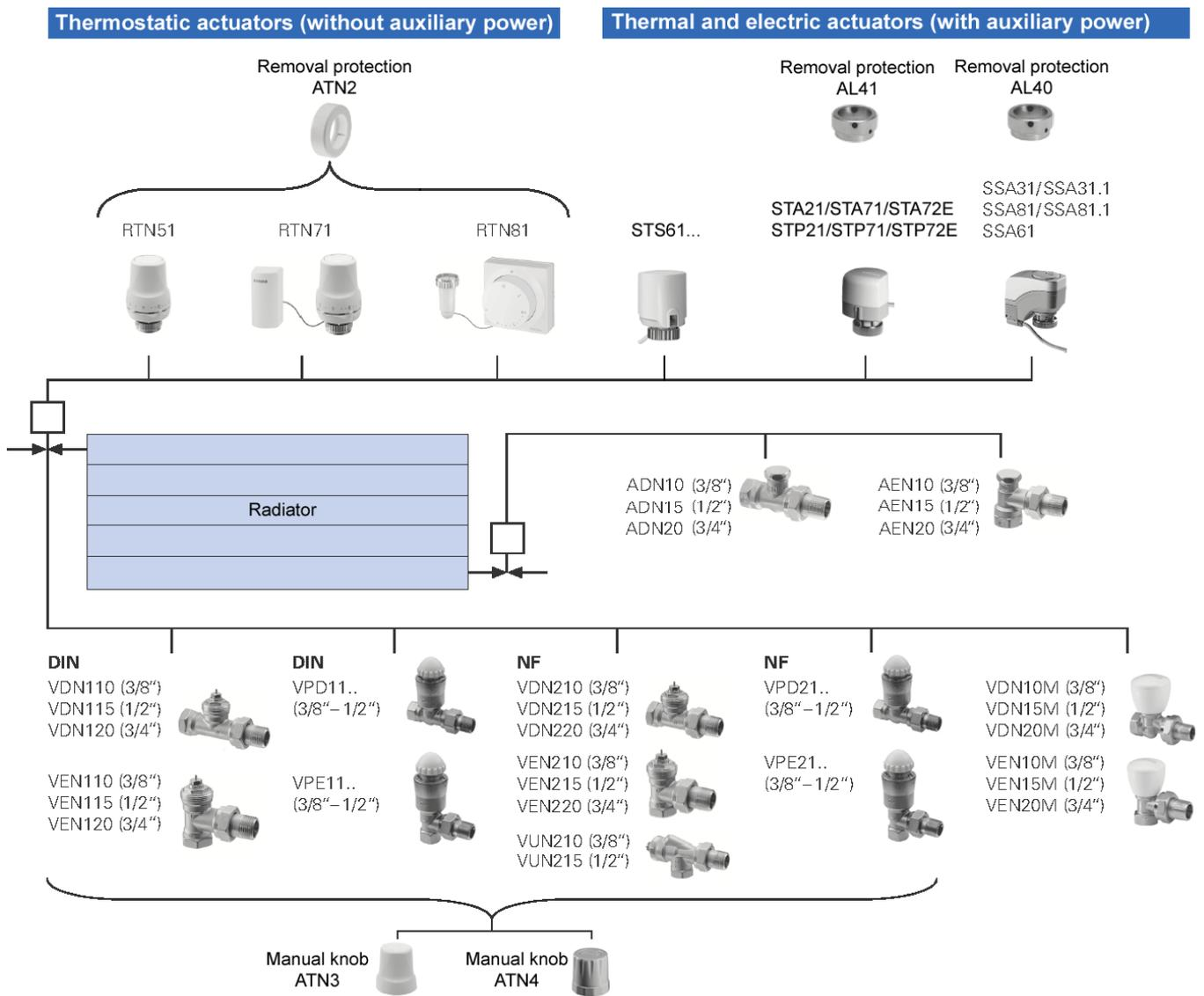
Комбинации оборудования: клапаны и соединительные детали
