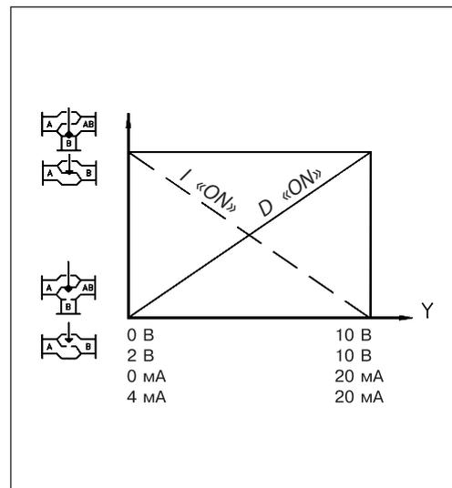
Во включенном положении электропривод работает в диапазоне 0(2)–10 В или 0(4)–20 мА, в положении «ON» — 0(2)–5(6) В или 0(4)–10(12) мА либо 5(6)–10 В или 10(12)–20 мА.
