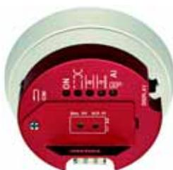
Тестер DB1191 базы извещателя является удобным и простым средством тестирования линии извещателей и соединений базы извещателя. Тестер базы помещают в базу извещателя так же, как и сам извещатель. Все базы AlgoRex DS11 можно тестировать либо отдельно при установке, либо в последовательном порядке после установки.
