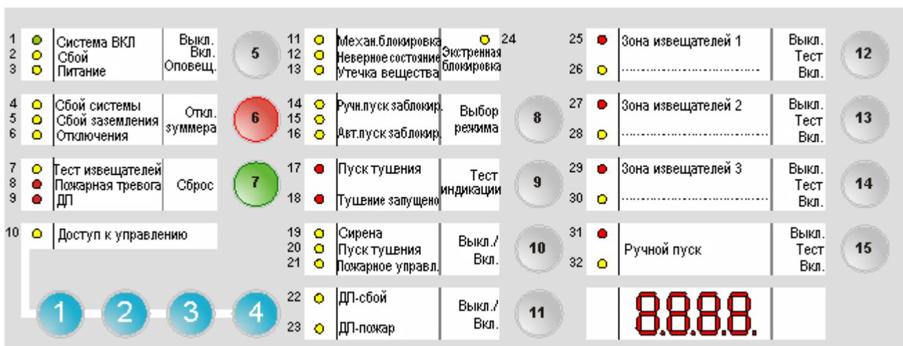
Рис.6 XC100x-A, интерфейс пользователя
