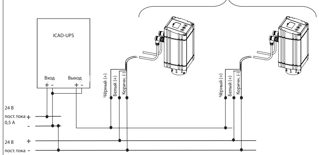
Один общий трансформатор на 24 В постоянного тока для ICAD-UPS и ICAD 600TS
