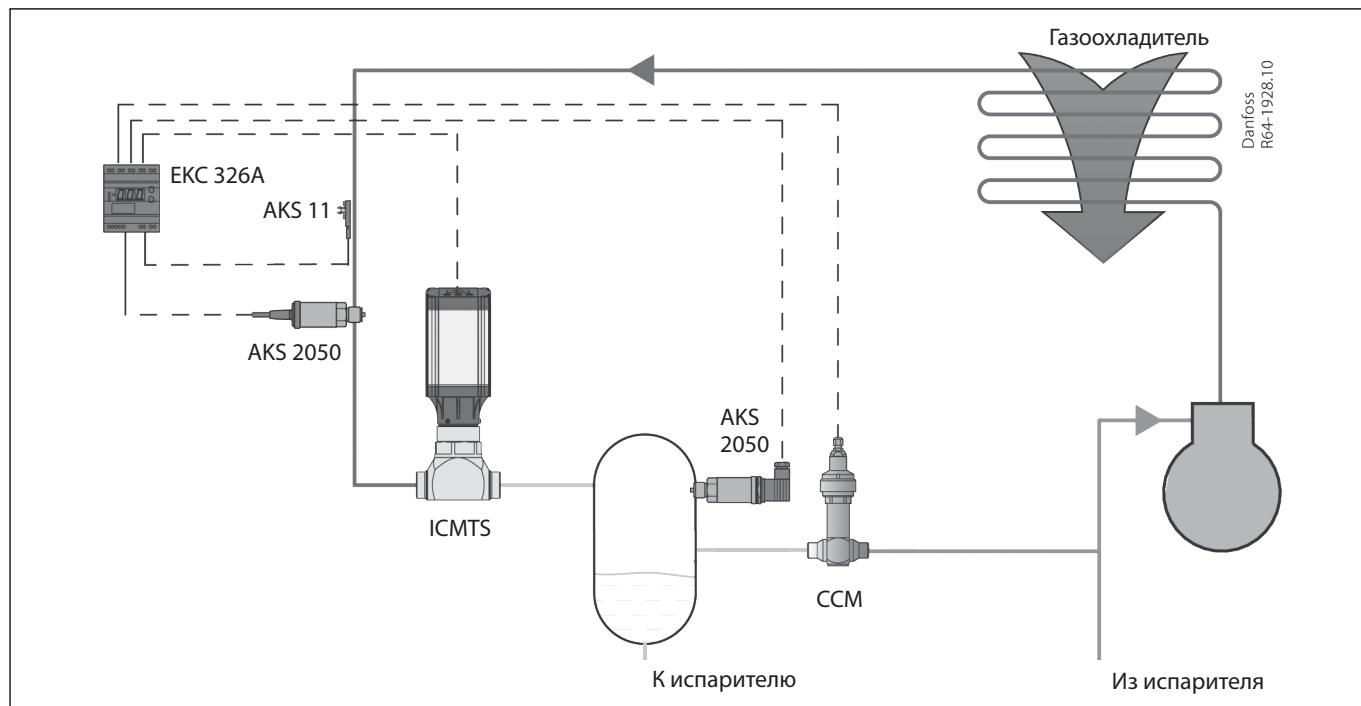
Клаапаны ICMTS разработаны для применения в закритических системах на CO<sub>2</sub>. Клаапаны ICMTS могут быть использованы в системах на линии перепуска горячего газа, параллельным сжатием, а также применяться автономно. Клаапаны ICMTS могут быть использованы в закритических и подкритических условиях.
