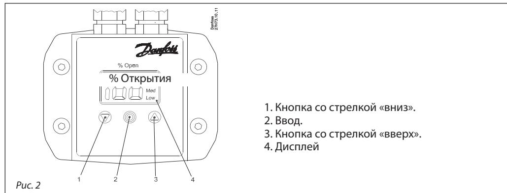
Привод ICAD 600A-TS оснащен интерфейсом «человек – машина» (MMI - Man Machine Interface), с помощью которого можно наблюдать за состоянием клапана и изменять различные параметры настройки для адаптации привода и клапана к конкретной холодильной установке. Изменение параметров выполняется с помощью встроенного в ICAD 600A-TS интерфейса MMI следующим образом (см. рис. 2 и 3):
