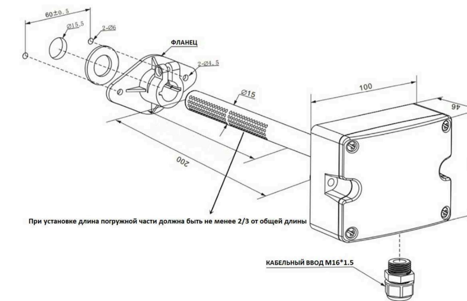
Как показано на рисунке, используйте метод фиксированной установки фланца: просверлите сквозное отверстие диаметром Ø 15,5 мм на кульке, сначала закрепите прокладку и фланец на воздуховоде, а затем вставьте стержень зонда в воздуховод (самое короткое положение установки фланца должно составлять ≥ 2/3 длины зонда), затяните фланцевые гребни, чтобы надежно закрепить стержень зонда. Установочные размеры показаны на рисунке.
