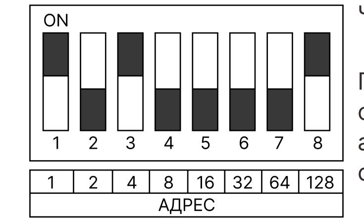
Примечание: включите питание еще раз, чтобы обновить DIP-адрес; только если DIP-адрес равен 0, адрес идентификатора устройства можно изменить с помощью программного обеспечения.
